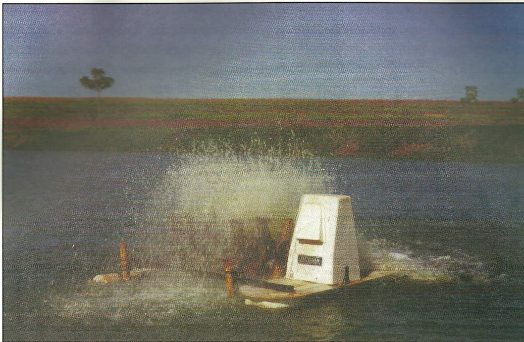
Figura 1 - Aerador para aumentar o teor de oxigênio dissolvido.
